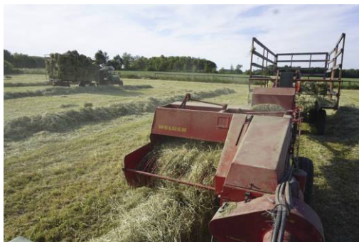
6a) Die Ballenpresse presst, bündelt und schleudert...
